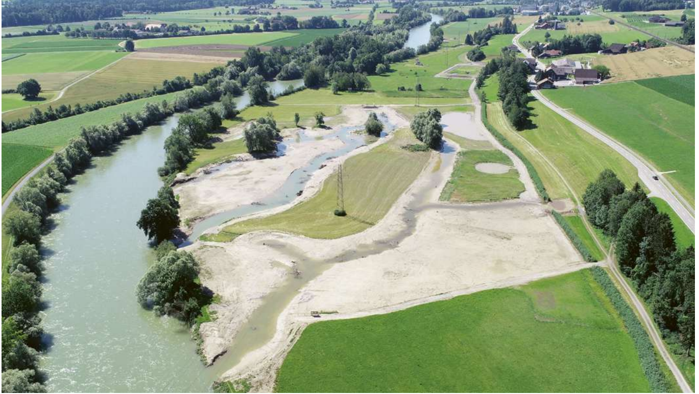
Drohnenaufnahme nach Abschluss der ersten Bauetappe. Die Aufnahme zeigt den aktuellen Zustand der Aue bei Mittelabfluss der Reuss im Jahr 2020. Der Durchstich des Seitenarms wird in der zweiten Bauetappe erstellt.
